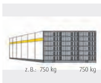
Punktlastverteilung mit Standard-Rollregalsystem.
