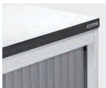
Bis 3 OH Gesamthöhe: Abdeckplatte melaminharzbeschichtet, 25 mm stark, abgerundete ABS-Umleimer.
